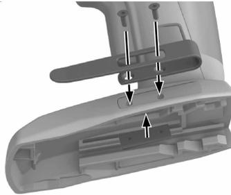
Con ayuda del colgador de cinturón puede fijar las herramientas eléctricas adecuadas a su cinturón. Se puede montar para llevarlo a la izquierda o derecha.
