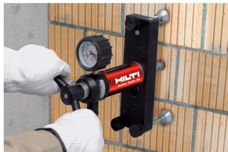
Для других типов пустотелого и полнотелого кирпича в кирпичной кладке, не описанных в данных ЕТА для химического анкера Hilti HIT-NU 270 или данном руководстве по техническим данным, нормативное сопротивление может определяться по результатам испытаний на растяжение, проводимых на площадке в соответствии с СТО 44416204-010-2010 “Крепления анкерные. Метод определения несущей способности по результатам натуральных испытаний”, или испытаний на приложение рабочей нагрузки по методике Hilti.
