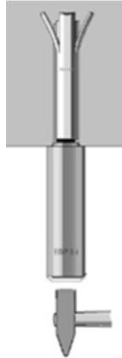
**4.** Выполняйте затяжку гайки до тех пор, пока не будет видно синее кольцо.
