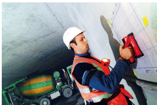
Рисунок 10.1 - Внешний вид прибора Hilti PS 250
