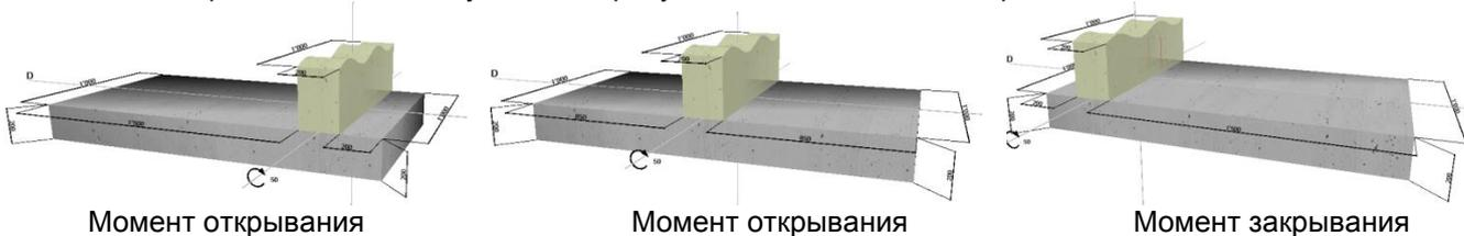
**Рисунок 6:** моменты открывания и закрывания, принятые в системе PROFIS Rebar
