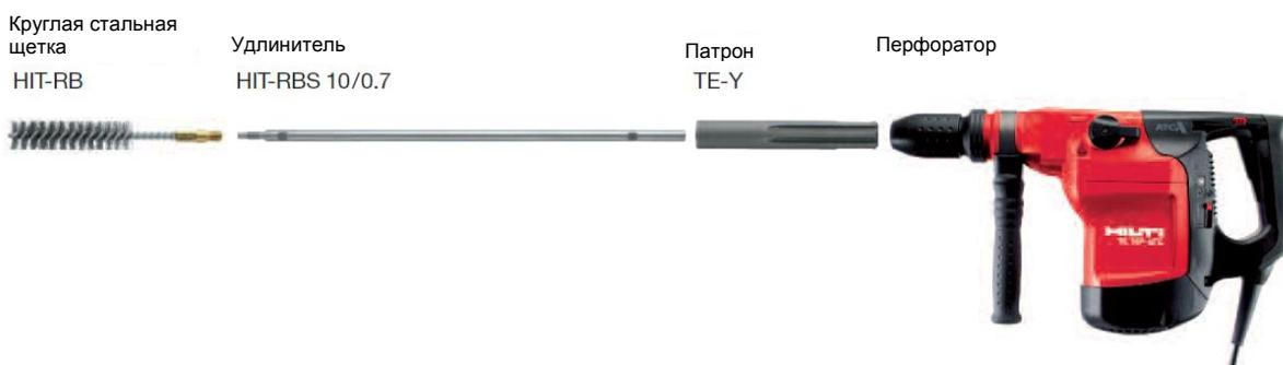
Навернуть круглую стальную щетку HIT-RB на конец щеточного (-ых) удлинителя (-ей) HIT-RBS так, чтобы общая длина щетки была достаточной для того, чтобы достать до дна отверстия. Присоединить другой конец удлинителя к зажимному патрону TE-C/TE-Y.
